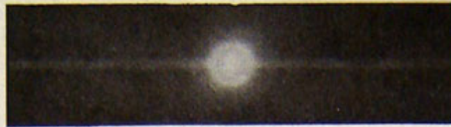
FIG. 24. — Bonne mise au point. Rayon perpendiculaire à la fibre.
