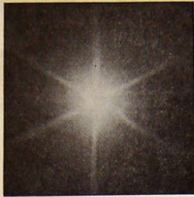
FIG. 27. — Déformation obtenue quand la mise au point est bonne.
